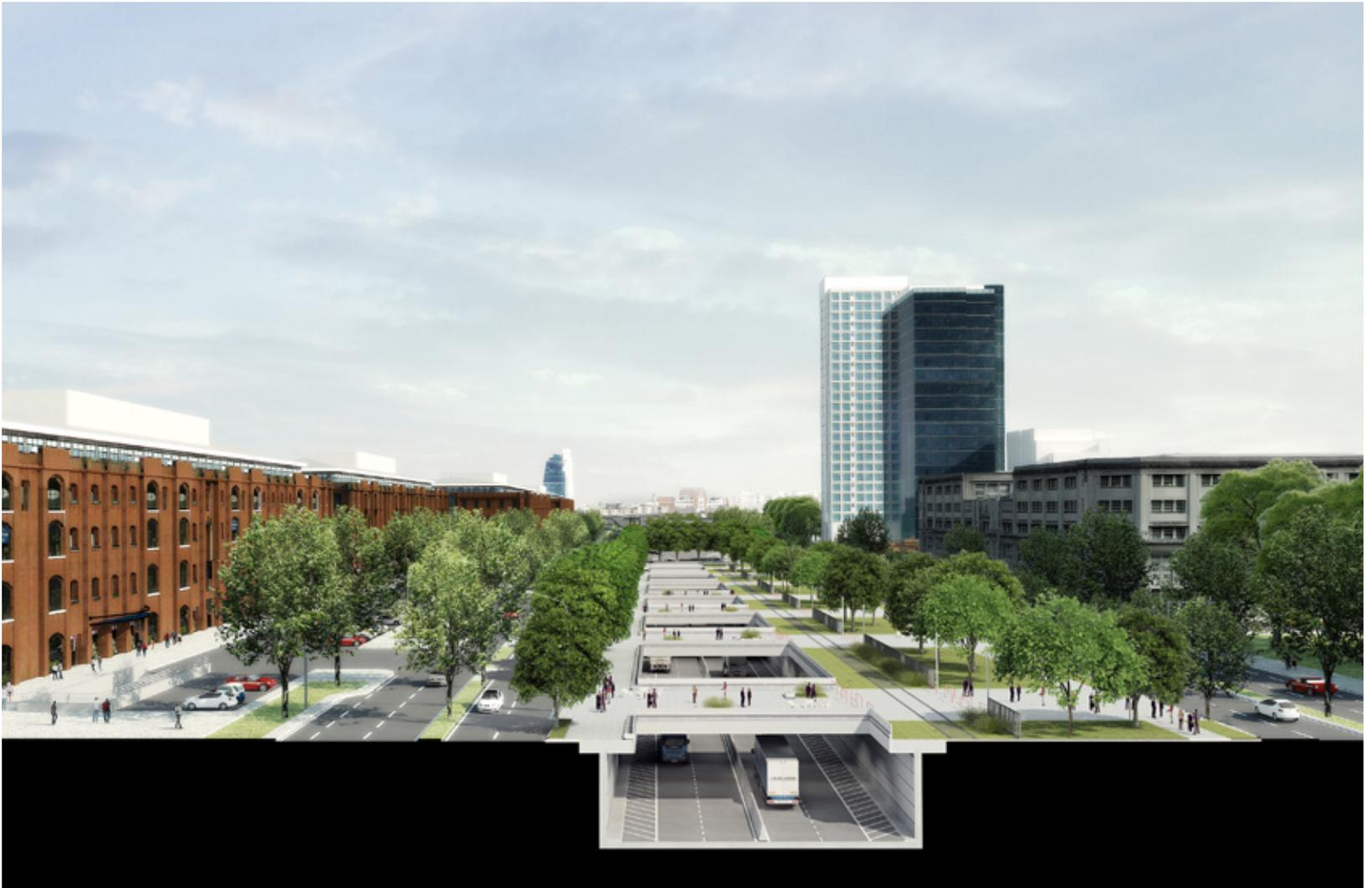
CORTE DEL PROYECTO DE LA OBRA PASEO DEL BAJO, TRAMO EN TRINCHERA
