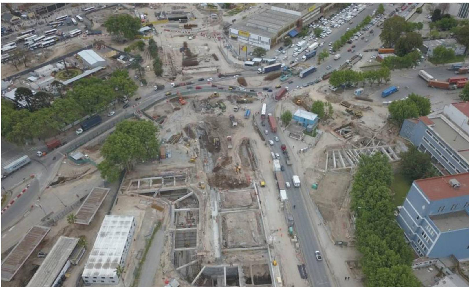
VISTA AÉREA DE LA SOLUCIÓN DE LAS INTERFERENCIAS HIDRÁULICAS EN EL TRAMO C, OCTUBRE 2018. SE APRECIA ESPECIALMENTE LA REUBICACIÓN DEL CONDUCTO DE TORMENTA SAN MARTÍN
