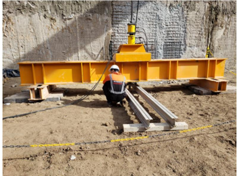
ENSAYO DE CARGA EN MICROPILOTES
